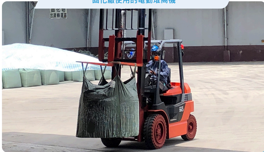
固化廠使用的電動堆高機
